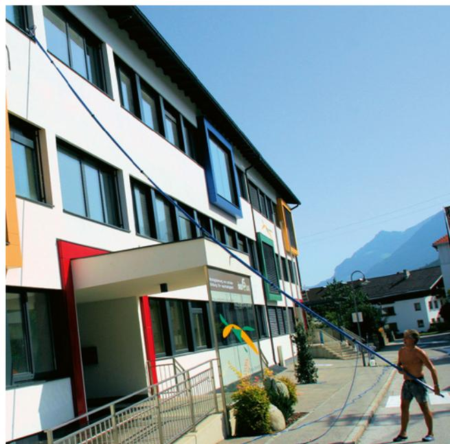
„S’nuie Gerät macht’s möglich: I selber steh auf sicher’m Bodn und putz dabei die Fenster im zwoatn Stock!“ erzählt Martin Ortner lächelnd und führt die Titanstange mit Schlauch und Bürste daran – von oben nach unten, von unten nach oben usw. usw. Das von einem angeschlossenen Gerät entmineralisierte Wasser trocknet rückstandsfrei auf und hinterlässt keine Schlieren.
